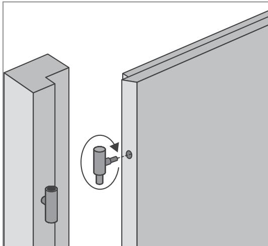
Hang opdekdeuren met een hoogtemaat van 201,5 en 211,5 cm af aan 2 paumellescharnieren. Deuren met een hoogtemaat van 231,5 cm dienen altijd aan 3 paumellescharnieren afgehangen te worden. Een opdek binnendeur kunt u alleen aan de onderzijde van de deur inkorten met maximaal 50 mm. Gebruik hiervoor een scherpe cirkelzaag voor een mooi resultaat. Zorg ervoor dat de ongegronde delen direct worden voorzien van een grondlak.
